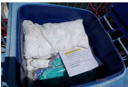
ภาพที่ 2-14 อุปกรณ์และเครื่องมือสำหรับกำจัดคราบน้ำมัน
